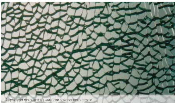
Структура осколков термически закаленного стекла
